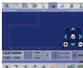
Séquence de pliage mode manuel
