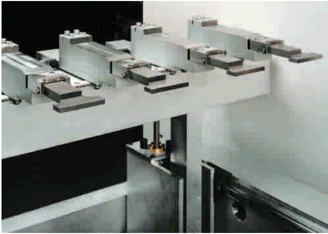
Butée arrière deux axes (X-R) avec axe Z manuel. Blocage pneumatique des doigts en position latérale sur PPEB-5
