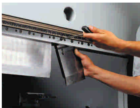
Serrage manuel mise en référence automatique du poinçon PP3090
