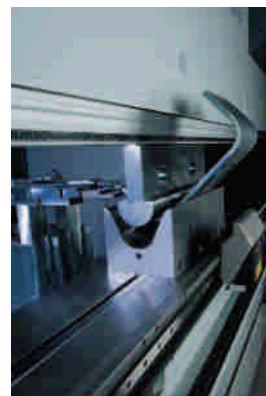
Serrage hydraulique mise en référence automatique du poinçon PP3100
