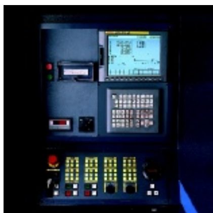
Le contrôle numérique 160i-L de GE Fanuc
