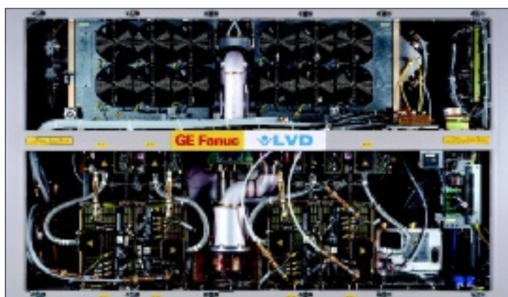
Le résonateur RF de GE Fanuc
