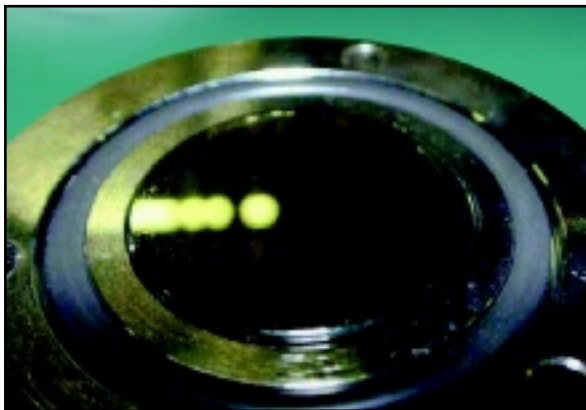
Miroir d'un résonateur avec un séparateur centrifuge.
