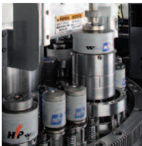
Une station fixe de 114,30 mm peut recevoir des grands outils de refendage, des outils à ouïes et de formes spéciales.
