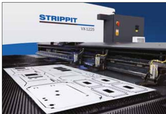
en gérant d'une manière efficace la consommation d'énergie. Avec une consommation électrique moyenne de 6,7 kw seulement et 0,9 kw en marche à vide, la STRIPPIT VX est l'une des poinçonneuses ayant la plus basse consommation d'énergie du monde.
